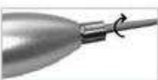
Убедитесь, что инструмент надежно закреплен; для этого делайте легкие движения по оси при каждой смене инструмента.
