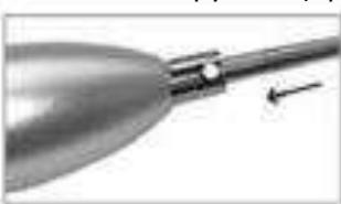
Поверните инструмент на 1/4 по часовой стрелке (влево), чтобы закрепить инструмент в байонете.
