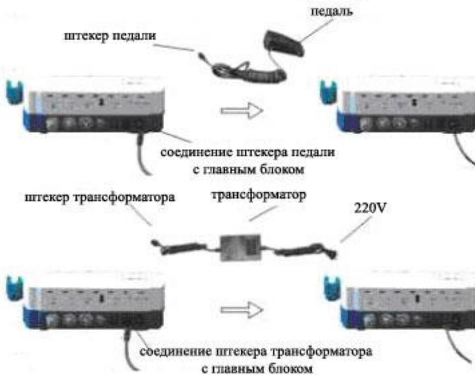
Рис. 2 Соединения главного блока с педалью и трансформатором
