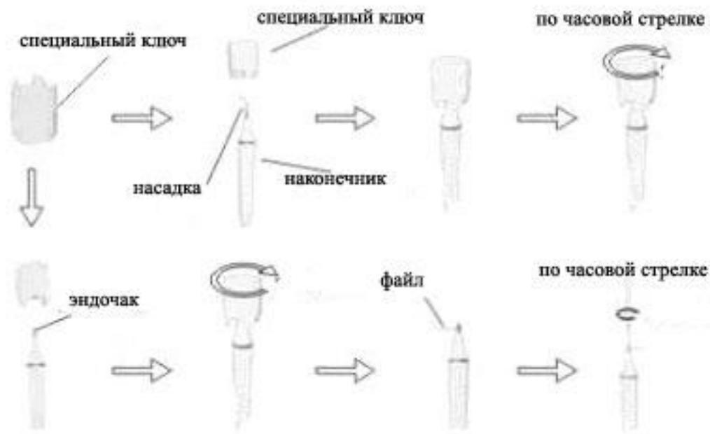
**Рис.6 Использование насадки скейлинга, эндочака при помощи специального ключа**
